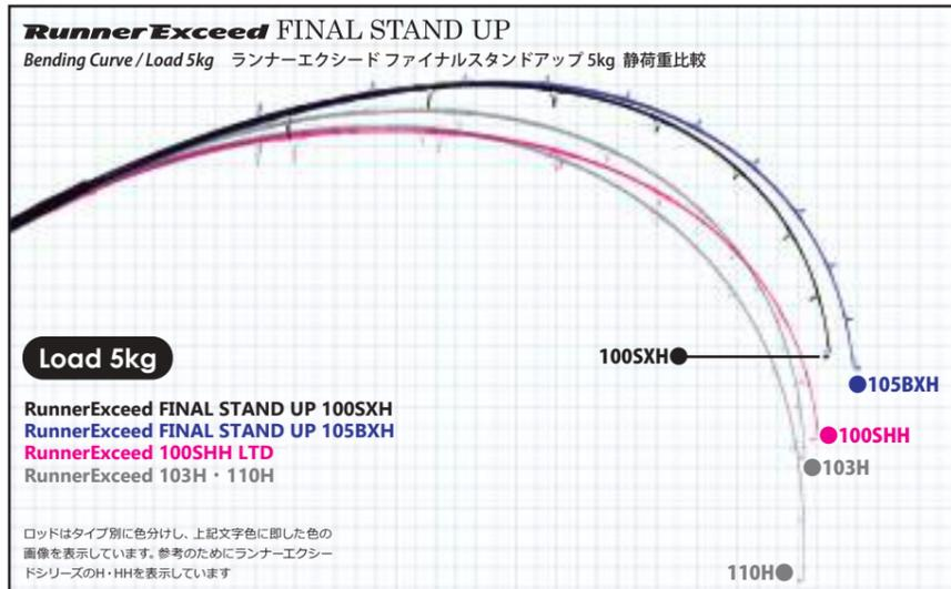
ランナーエクシード・ファイナルスタンドアップと同シリーズのH・HHクラスに5kg静荷重を掛けた曲がり比較です。シリーズ最強のファイナルスタンドアップはショアGTをメインとした大型魚専用ロッドであり、100SHHはそれに次ぐパワーモデルです。設計上のパワー設定は下記の特性比較も参考にしてください。103H・100SXH・105BXHは硬さを武器にした作りであり、110H・100SHHはNanoブランクによる曲がりと高弾性の生み出す高反発力を生かした耐えて浮かせるロッドになっています。この比較の中で、100SHHは特殊なカーボン素材を組み合わせた高弾性モデルになります。軽快なキャストフィールと軽い力でルアー操作が可能でパワーモデルであり、曲がり比較で見れる柔軟性とかけ離れたシャープな使用感になっています。
