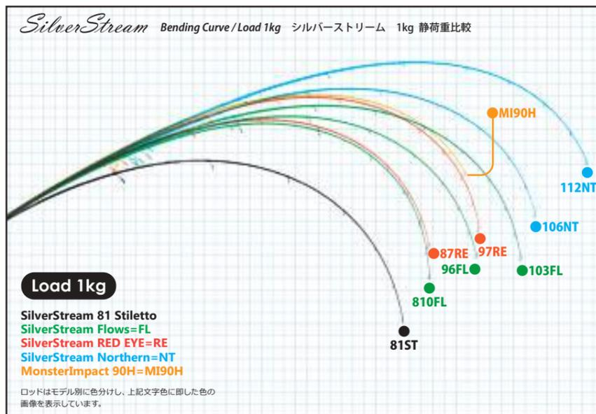
シルバーストリームシリーズに1kgの静荷重を掛けた状態の曲がり比較です。81ステイレットはオール40tカーボンのみで組み上げた高弾性・超高感度モデルであり、極限のショートバイトを掛けにくいハイスピードモデルです。ノーザン2機種はメタルジグ・ジグミノーなどの比重の大きいルアーを遠投するためのモデルであり、キャスト時の張りは強めですが、サクラマス等のフッキングに無理のない柔らかさのバランスを調整したモデルです。アロウスの3機種は全てシーバス仕様であり、レギュラーファーストな高感度モデルが810、全体に張りの強い遠投モデルが96、103はサーフでのヒラメも視野に入れたロングレンジ遠投モデルです。レッドアイはシーバス&アカメ用のモデルで、粘り重視のパワーモデルになり、曲がりは大きいですが懐は深く、魚をいなす性能を高めています。同じゲーム用のハイパワーモデルでビッグアール対応のモンスターインパクト90Hも参考に表示してあります。レッドアイがブランクに乗せて撃ち出すキャストならば、MI90Hはブランクの張り強さと強さで初速を上げて振り抜くキャストになります。
