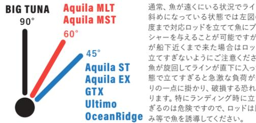
通常、魚が速くいる状況でラインが斜めになっている状態では左図の角度まで対応ロッドを立てて魚にプレッシャーを与えることが可能ですが、魚が船下近くまで来た場合はロッドを立てすぎないようにご注意ください。魚が旋回してラインが直下に入った状態で立てすぎると急激な負荷が曲がりの一点に掛かり、破損する恐れがあります。特にランディング時に立てすぎると危険ですので、ロッドは脇挟み等で魚を誘導してください。
