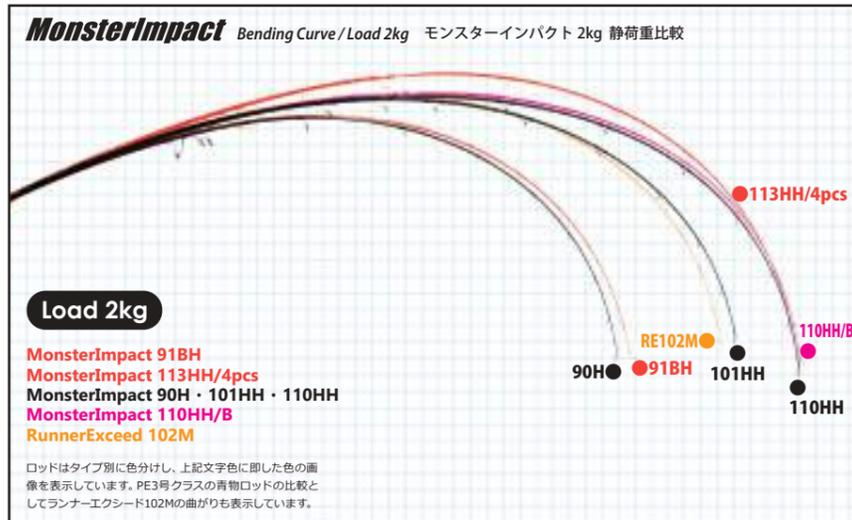
ランカーマルスズキ・アカメ用モデル、ヒラスズキ・青物兼用モデルであるモンスターインパクト6機種種の2kg静荷重比較です。2021年の新製品であるベイトモデル91BHは90Hより更にビッグアーの使用上限を上げたモデルで、メインターゲットはランカーシーバス・アカメですが、使用感はあくまでシーバスモデルクラスの軽快さです。4ピースモデルの113HHはシリーズで最もパワーのあるモデルになり、強度も高めつつキャスト時のシャープな振り抜けを追求したモデルで、メインターゲットは磯のヒラスズキ・青物です。101HH・110HH・110HH/Bもヒラスズキ・青物兼用モデルであり、全体的に張りがあるのは110HH、110HHベイトモデルであり、硬さと粘りを両立した剛性の高いブランクです。ほぼ同パワーでティップが入りやすく、曲がり溜めやすい設計にした粘り重視のモデルが101HHになります。
