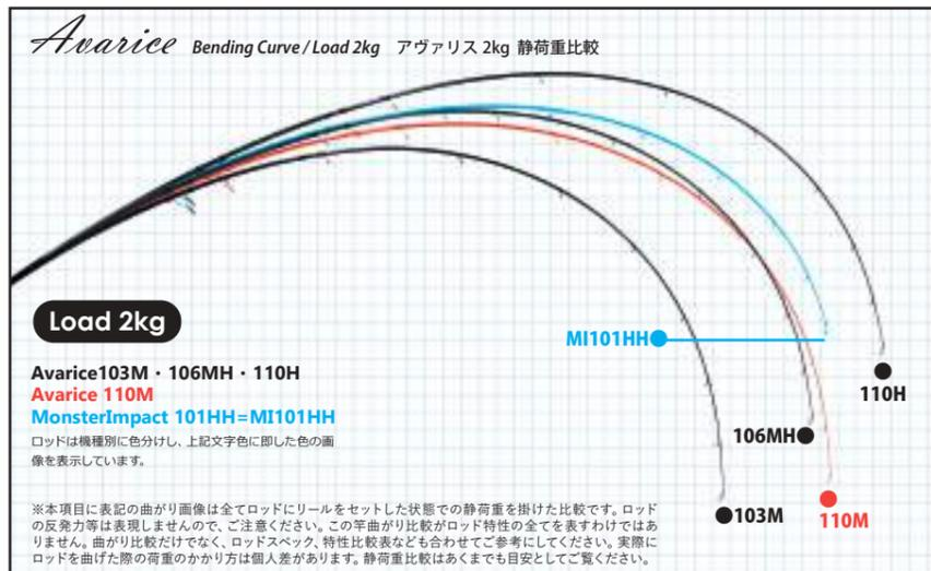
ヒラスズキモデル・アヴァリスシリーズに2kgの静荷重を掛けた曲がり比較です。参考までにモンスターインパクト101HHを表示してあります。110Mは103Mのロングレンジス&パワーアップモデルという位置付けです。106MH・110Hがキャストフィール重視のピンポイント撃ち&パワーモデルとすれば、110Mは乗せ重視の調子にシャープな使用感を融合したモデルです。シリーズでは103Mが最も曲がりやすく、走り回れる平磯をメインに想定しています。106MHは標準的なヒラスズキモデルですが、バットパワーは強めです。110Hは足場の限定される厳しいフィールドに対応するモデルで、パワー的には青物5kgクラスとも渡り合えるロッドです。110Hとモンスターインパクト101HHと比較するとバットパワーは110Hが大きく上回りますが、ティップはあくまでミノーメインの繊細さを持っています。
